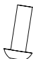
15 Шестигранный винт с плоской круглой головкой M4*10 x2 内六角平圆头螺丝M4*10
